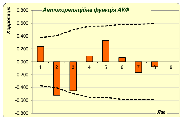
Рис. 3. Автокореляційна функція сигналу з фотодатчика за \tau = 2
